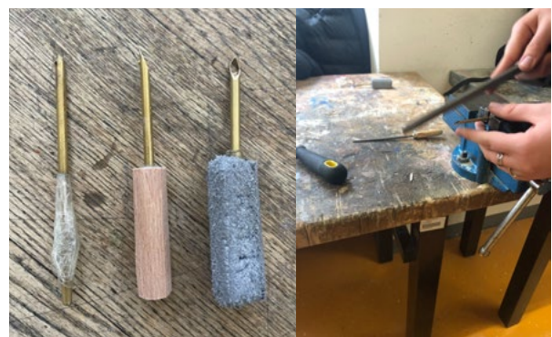
Abb. 3 | Herstellung der Tuftingnadel mit unterschiedlichen Griffen
