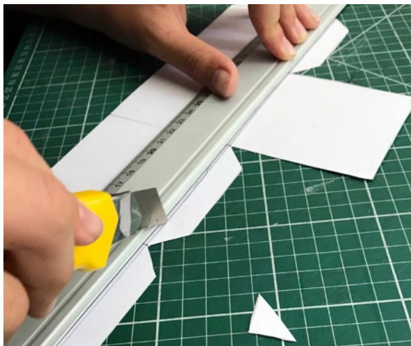
Abb. 3 | Anritzen und Falten mit Schneidmesser oder Falzbein
