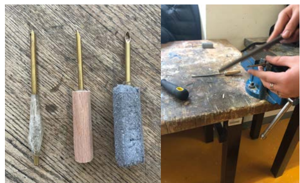
Abb. 3 | Herstellung der Tuftingnadel mit unterschiedlichen Griffen
