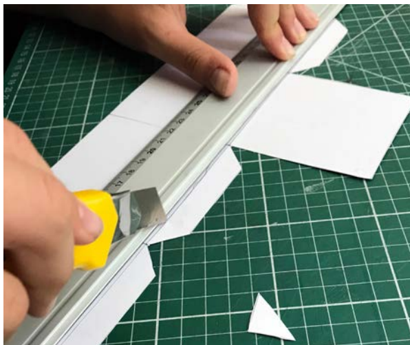
Abb. 3 | Anritzen und Falten mit Schneidmesser oder Falzbein
