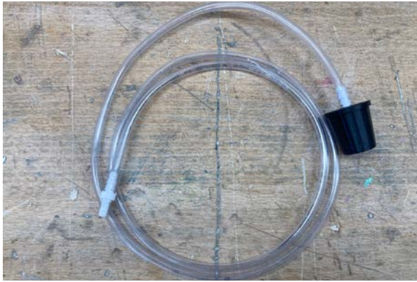
Abb. 3 | 3D gedrucktes System mit Schlauch zur automatischen Druckbegrenzung
