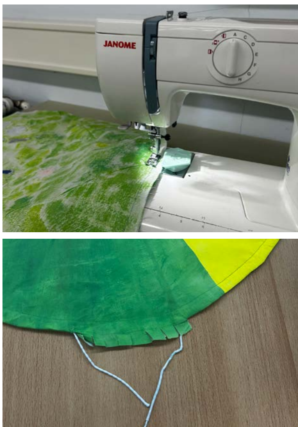
Abb. 7–8 | Zusammennähen (rechte auf rechte Seite, verstärkt mit Bleiband)
